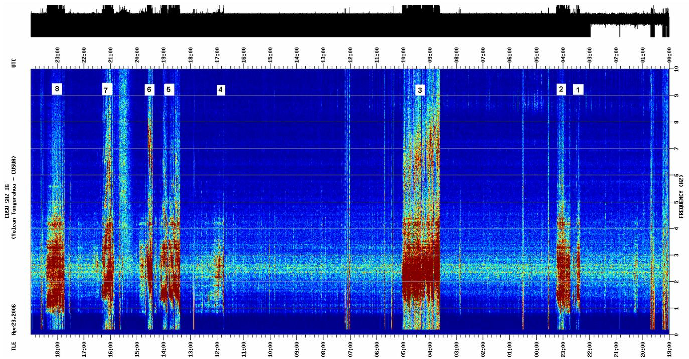
**Figura 1.** Espectrograma (variación de frecuencias y amplitudes con el tiempo) de la actividad sísmica del Tungurahua el 23 de abril, registrada en la estación de Cusúa (a 6 km de distancia del cráter). Obsérvese los episodios de tremor marcados.
