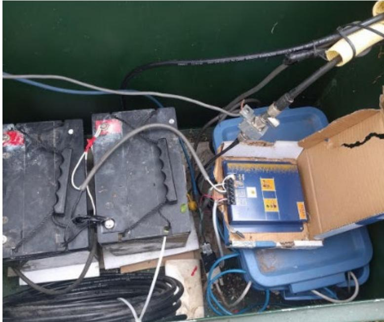
**Figura 4.** Se cambió las baterías del GPS e inclinómetro de la estación Mazón en día 03 de enero con el apoyo del vigía de El Manzano, Sr. Vicente Reyes.
