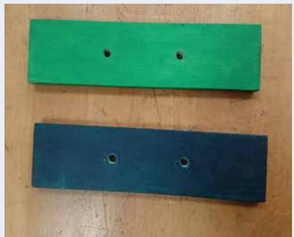
5. Armar los bloques colocando una de las piezas pequeñas sobre la parte central de una de los bloques grandes y realizar dos agujeros que los atraviesen. Realizamos el mismo procedimiento con el par de maderas que sobran.
